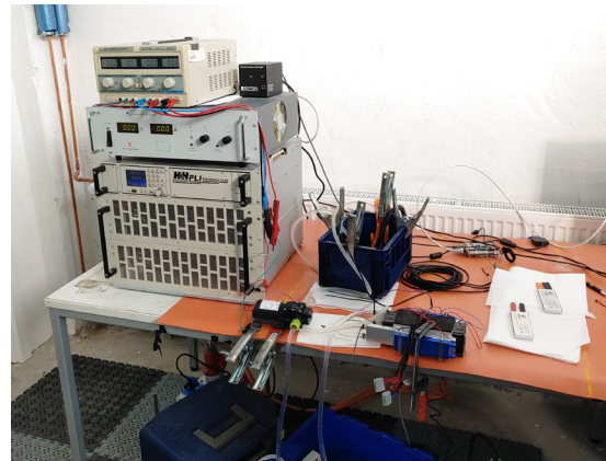
Testaufbau für Belastungs-, Temperatur- und Zykientests
