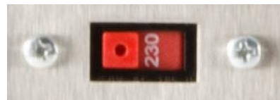
Abbildung 1.1: Netzspannungswahlschalter an Unter- oder Rückseite
