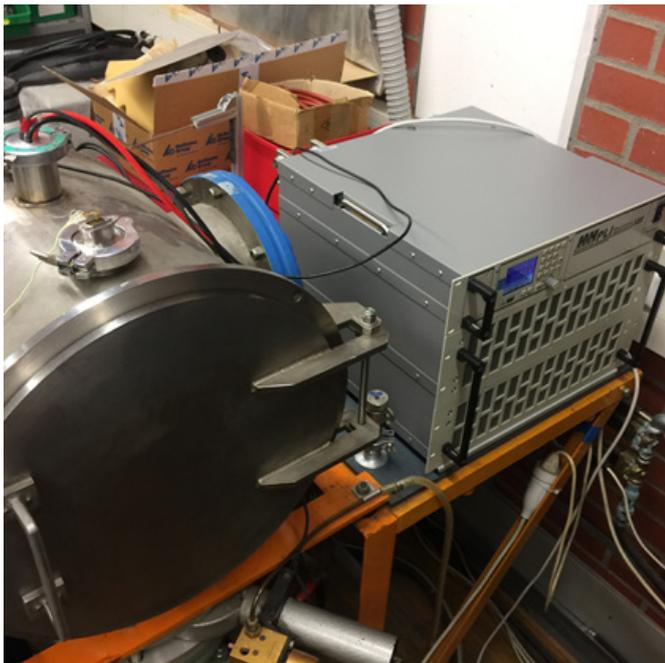
Vakuumkammer und elektronische Last PLI6404
