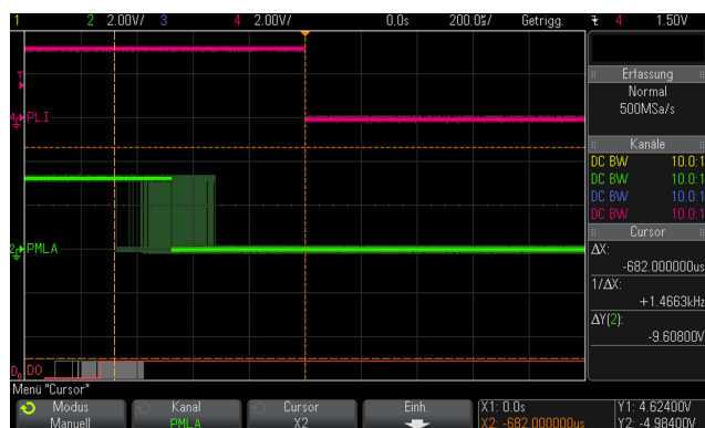
Abb. 7: Ansteuerung des Lasteingangs bei PLI und PMLA ohne Verzögerungszeit (Langzeitaufnahme mit Nachleuchten)
